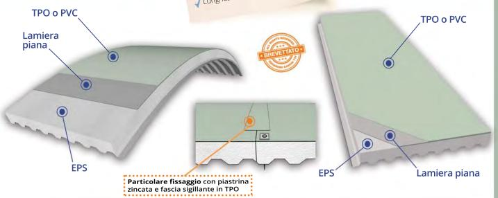
Pannello metallico per **copertura retto o curvo a raggio variabile**, costituito da una lamiera esterna piana zincata, pre-accoppiata con un **manto sintetico in TPO Poliolefine o PVC**, da una lamiera interna grecata in acciaio zincato e preverniciato, avente uno spessore da 0,4 a 0,8 mm (secondo richiesta e disponibilità), e da un coibente interposto tra le lamiere in polistirene espanso sinterizzato **EPS Bianco o Grafite**, avente spessore da 40 a 200mm.
